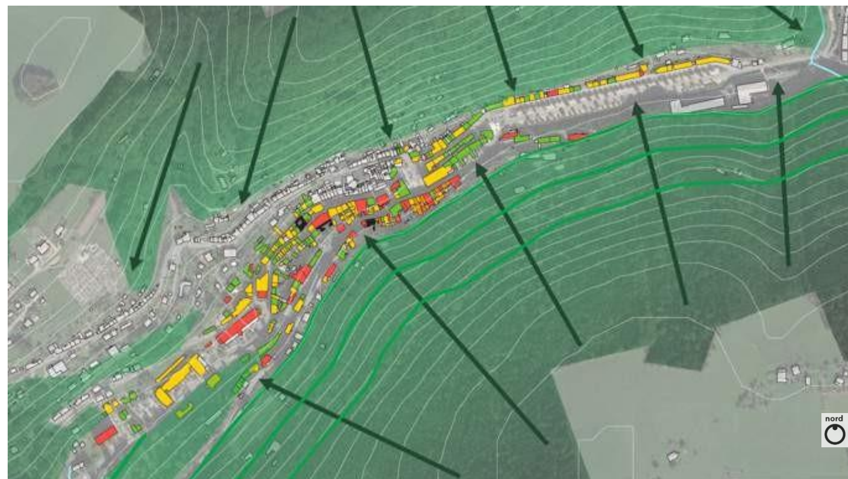
Relevé sommaire d'une partie de la dégradation bâtementaire de Plombières les Bains En noir, les bâtiments en très mauvais état (insalubrité potentielle), en rouge les bâtiments vétustes, en jaune en mauvais état
